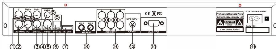
**1. Component-Video-Ausgang** – Videoausgang für Y-, Pb/Eb-, Pr/Cr-Component-Kabel.
